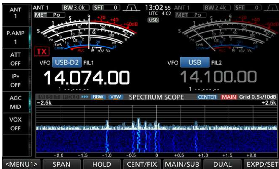
運用モードをUSB-D2、BWを3.0kに設定した例 (FT8の電波を受信中)
