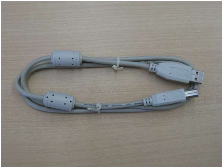
市販USBケーブルの例 (回り込みなどを未然に防止するため、フェライトコア入りがおすすめ)
